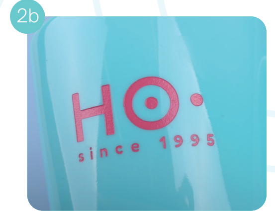
Barwienie z zewnątrz i piaskowanie (grawer głęboki) z wypełnieniem kolorem
